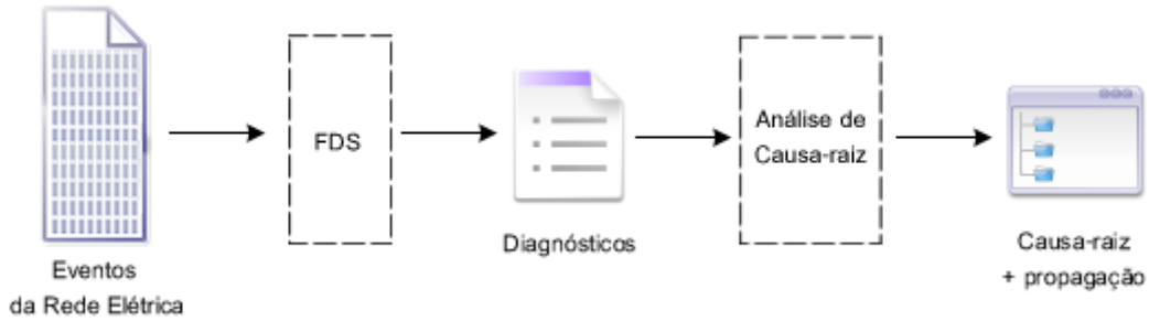
Figura 3.1: Processo de interpretação de uma ocorrência de falha no sistema elétrico
