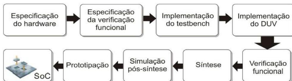
Figura 1 - Fases do processo de desenvolvimento de *hardware* na ordem proposta por VeriSC (SILVA, 2007).
