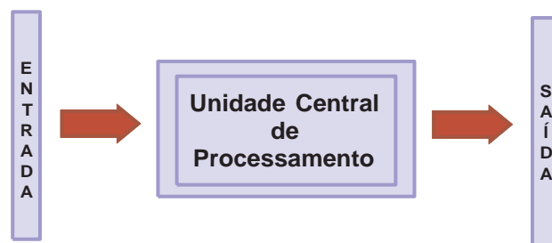
Figura 3.1: Estrutura básica de um CLP
