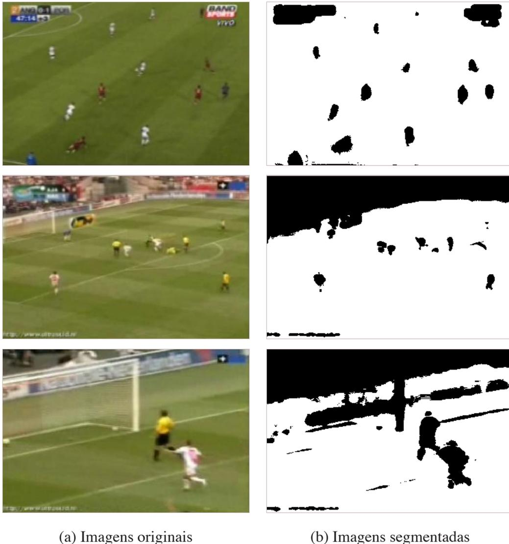
**Figura 4.4:** Resultados da aplicação segmentador obtido utilizando o método proposto ao problema da detecção de grama (grama em branco e demais regiões em preto).
