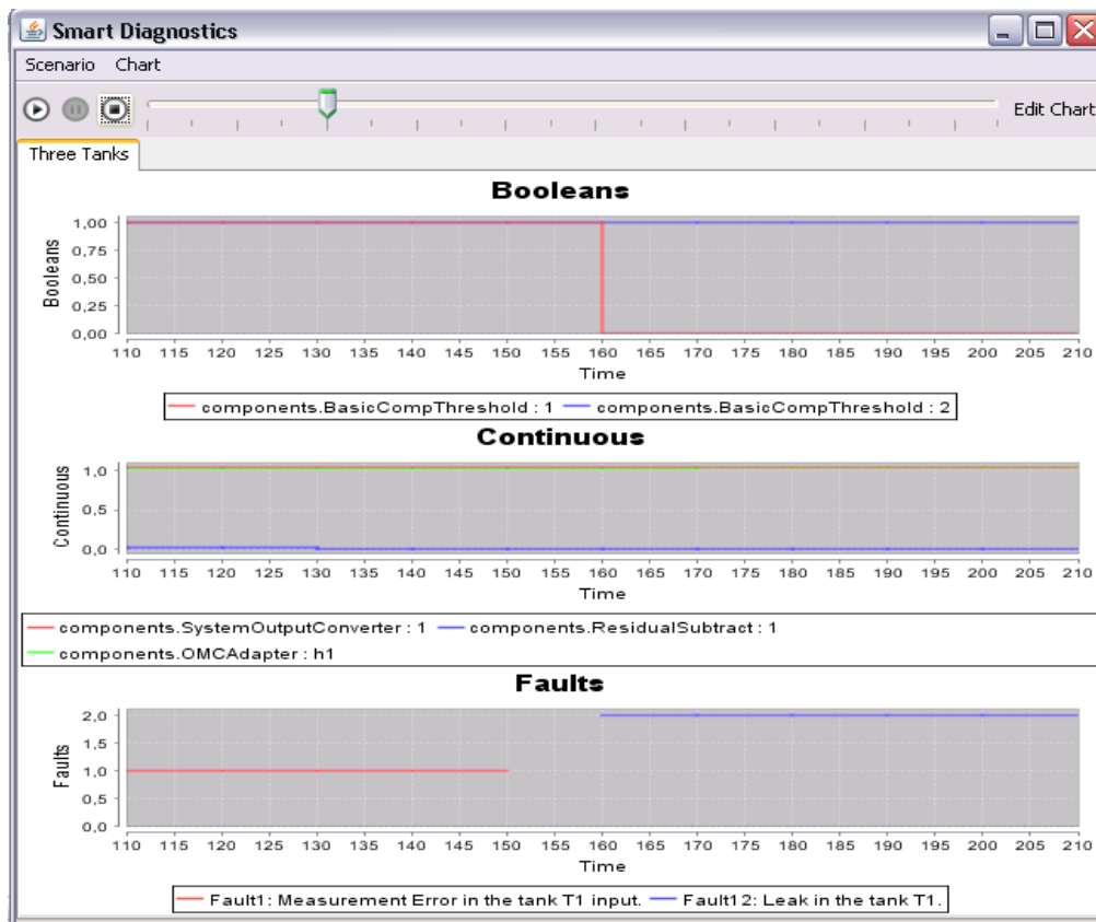
Figura 22: Vazamento no tanque T1.
