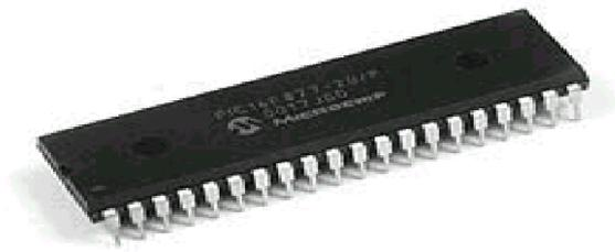
**Figura 3.2: Microcontrolador PIC16F877**
