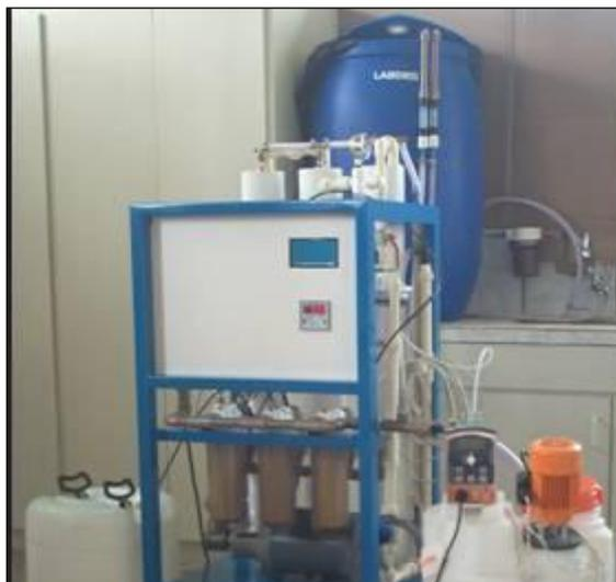
**Figura 2.6: Sistema de Dessalinização Piloto (SDP)**
