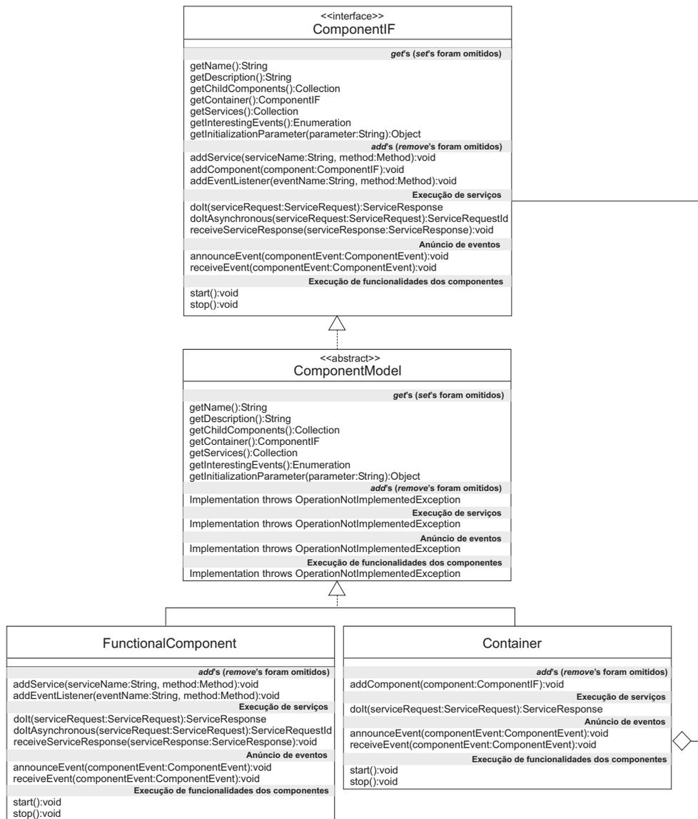
Figura 5.1: Diagrama de classes do arcabouço COMPOR-F
