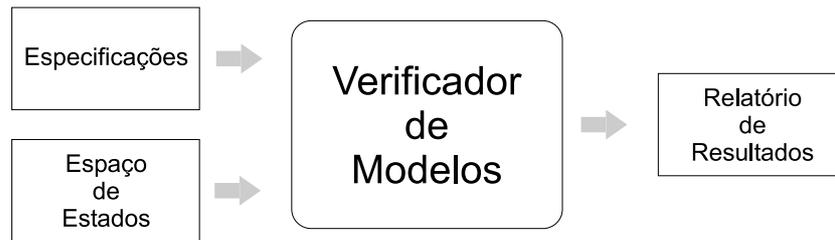
Figura 3.2: O processo de verificação de modelos em RPOO
