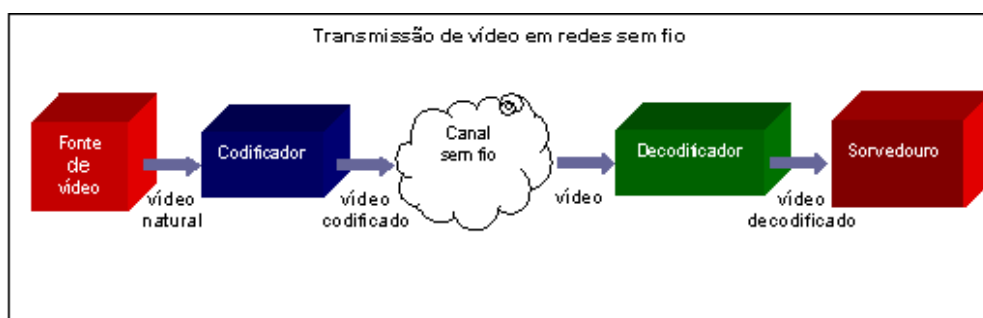
Figura 2-1: Esquema geral de uma transmissão de vídeo em redes sem fio.
