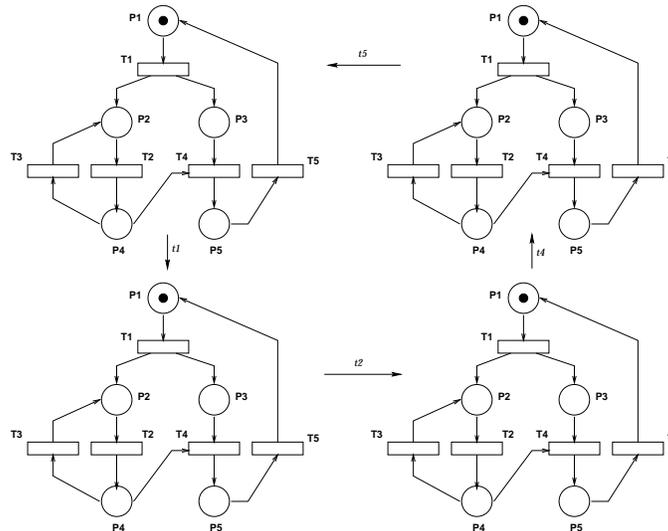
A Figura A.1 ilustra, na forma de um grafo, todos os acionamentos possíveis das transições da rede da Figura A.1.
